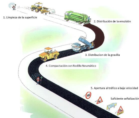
Figura 1. Etapas o pasos que deben de seguirse para la colocación de un riego de sello con gravilla.
